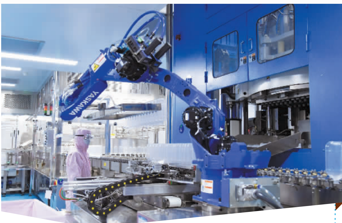
在石家庄四药集团智能化输液车间一期项目直立式软袋输液生产线,智能机器人手臂高效精准地进行输液药品的生产。
