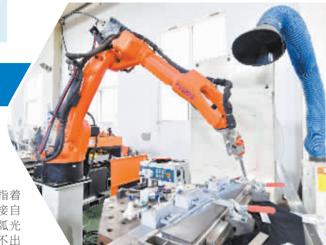
图为日前,位于藁城区的河北创联机械制造有限公司焊接车间,工业机器人进行产品焊接作业。本报记者 张晓峰 摄
