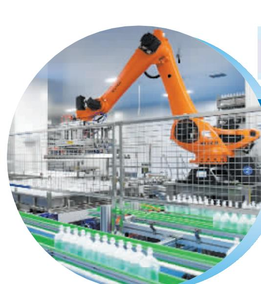
图为在石四药数智化直立式软包装输液生产车间内，智能机械手臂正在进行药品的自动化生产。
