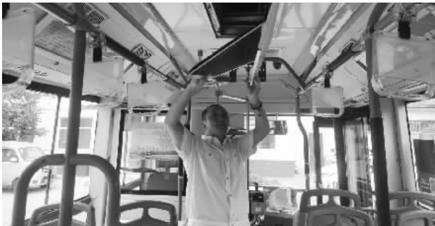
图为18路车队工作人员清洗空调滤网。张海静 供图
