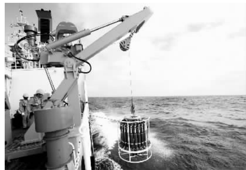
12月3日,考察队员在“沈括”号上进行CTD采水作业。中国多家机构联合组成的“彩虹鱼”2018马里亚纳海沟海试与科考团队已抵达西太平洋第一个深海站,12月4日成功进行基于我国北斗卫星通信系统的4500米级大深度剖面浮标海试。
